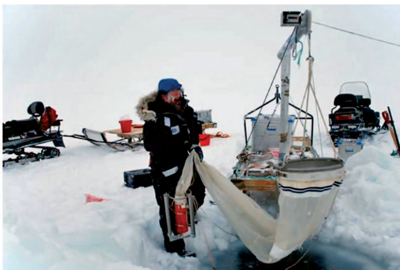
Fot. 2.6. Opuszczanie siatki planktonowej pod lód dla zebrania zakwitających glonów (Rijpfjorden, 80° równoleżnik)
