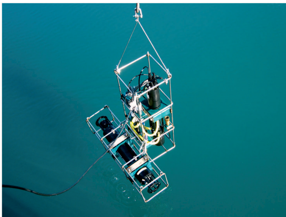
Fot. 2.12. Zespolony system pomiarowy rozkładu zooplanktonu
