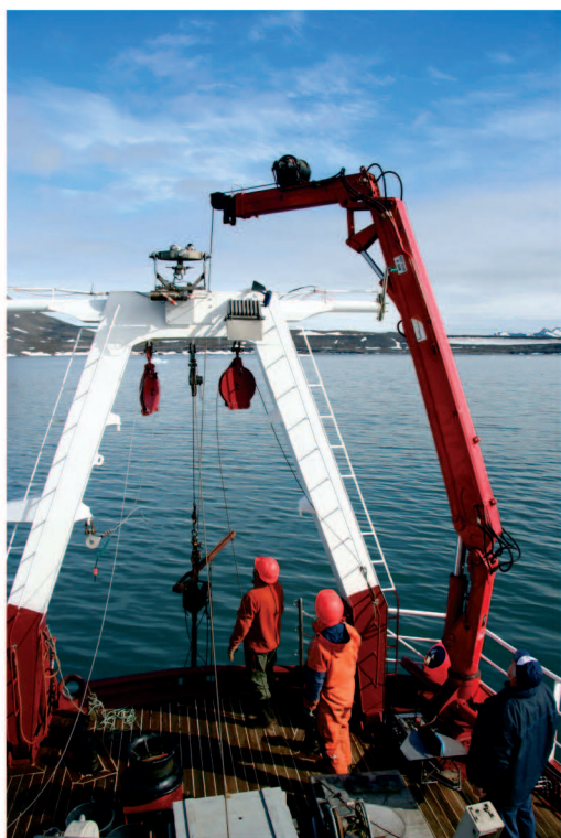
Fot. 2.23. Opuszczanie sondy rdzeniowej dla pobrania osadów zachowujących informacje o zmianach klimatu w czasie ostatnich kilkunastu tysięcy lat
