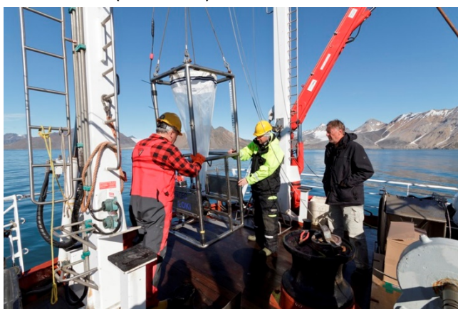
Rysunek 4. Urządzeni Video Plankton Rekorder LOKI na pokładzie s/y Oceania przed wykonaniem obserwacji.
